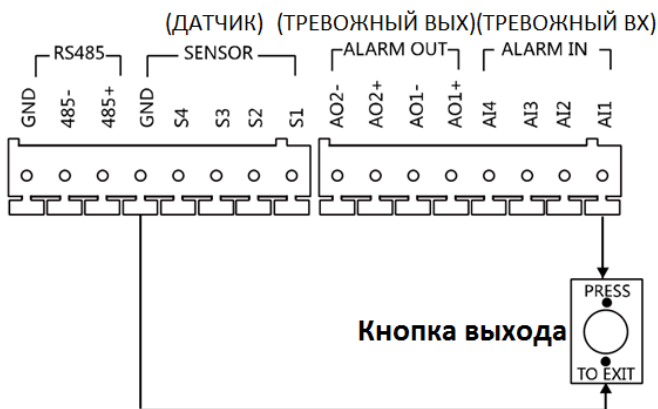
Рисунок 5-20 Подключение кнопки выхода для моделей DS-KD8102-V/DS-KD8002-VM (1)
